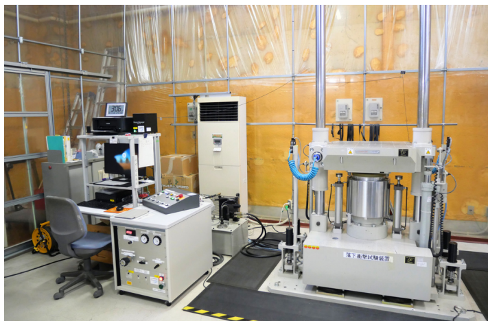
置賜試験場内 衝撃試験機 ASQ-700
