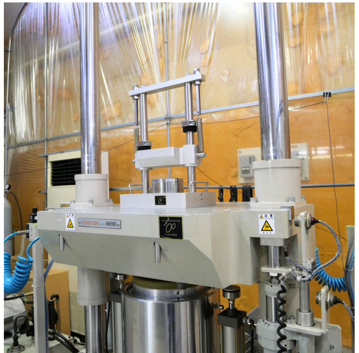
高加速度発生装置を設置した衝撃試験機
